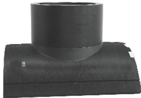
**Frialen XL®** " Spigot Saddle" La instalación de Branch Saddles es extremadamente fácil con Spigot Saddle XL. Posicione el fitting en su lugar, preinstálelo bajo condiciones de vacío utilizando VACUSET XL, electro-fusión y deje enfriar. (400-1200 mm, consultar por las derivaciones disponibles).
